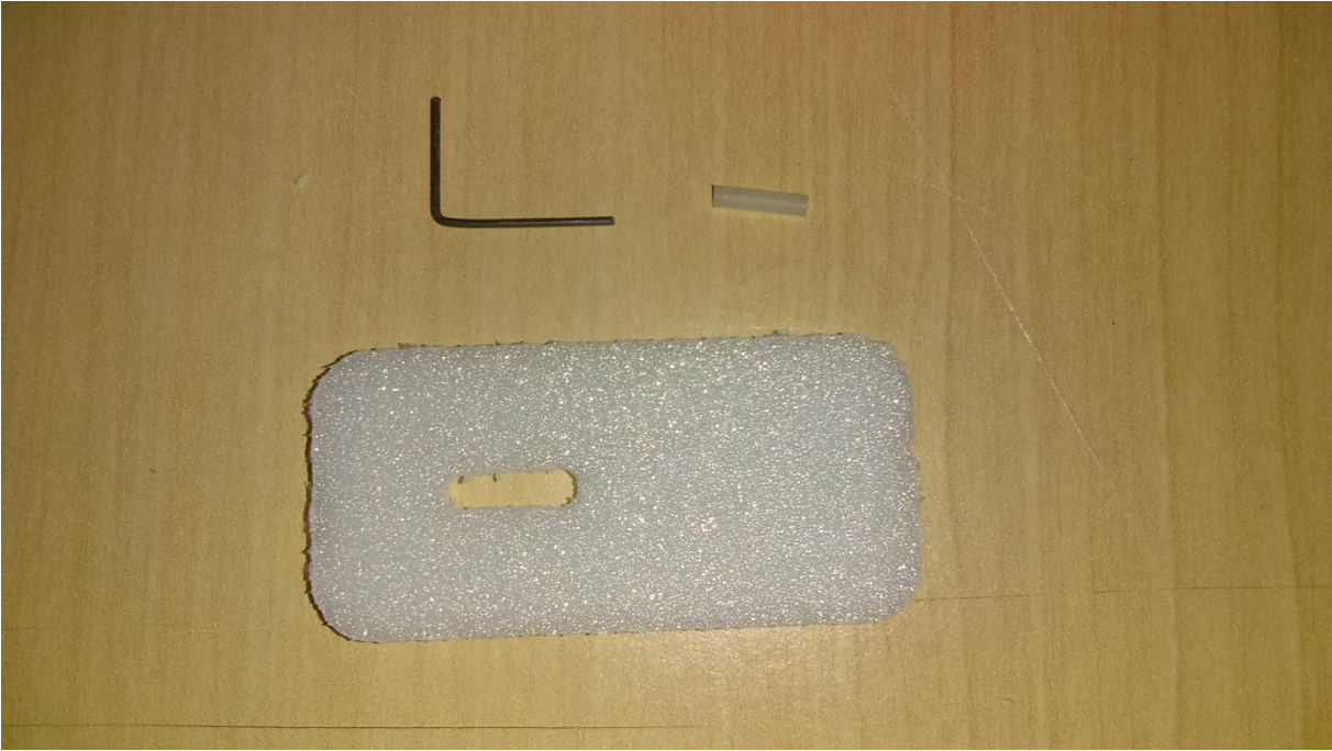
Bowdenzugröhrchen mit Drahtwinkel an den Deckel kleben
