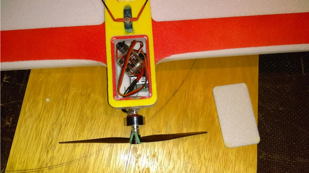
Empfänger einbauen und Deckel aufkleben
