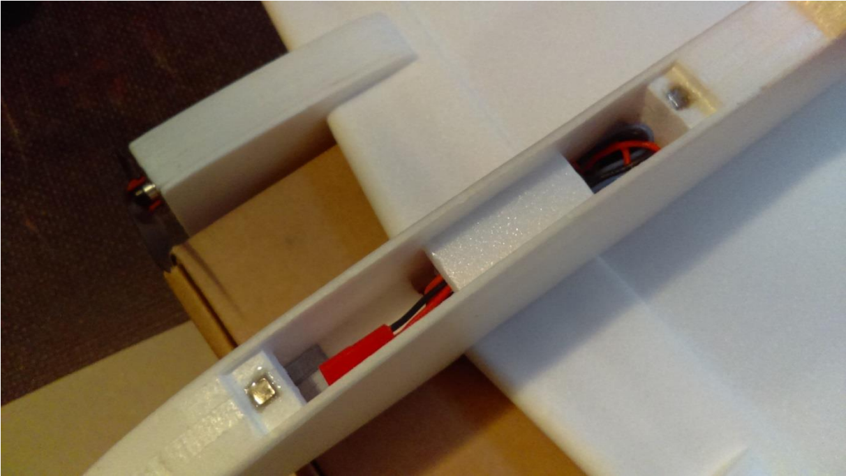
RC Anlage einbauen und Rumpfverstärkung einkleben
