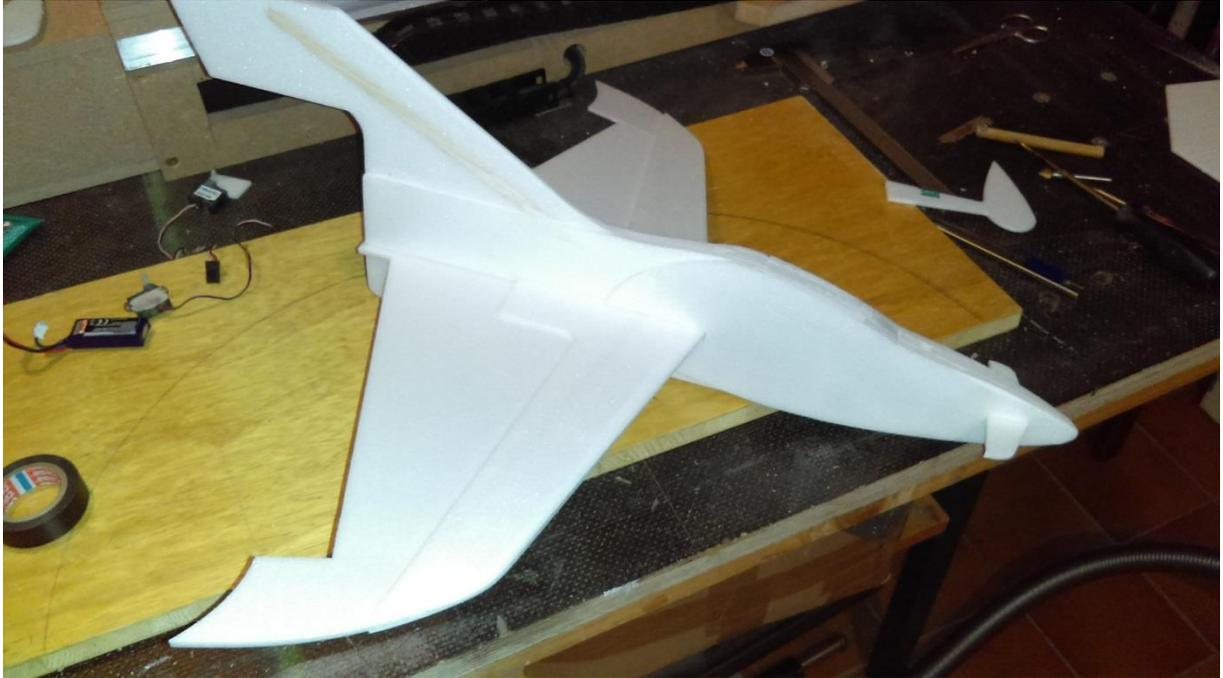
Fahrwerk und Kohlefaserstäbe 1,5mm verkleben
